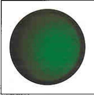
Abb. 10a Fernglas ohne P-Belag zwischen zwei gekreuzten Polarisatoren mit der Dachkante parallel zur Polarisatorachse
