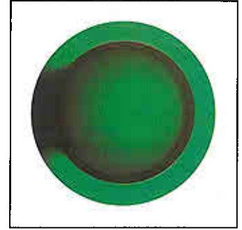
Abb. 10d Fernglas mit P-Belag zwischen zwei parallelen Polarisatoren mit der Dachkante parallel zur Polarisatorachse
