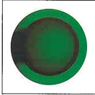
Abb. 10b Fernglas ohne P-Belag zwischen zwei parallelen Polarisatoren mit der Dachkante parallel zur Polarisatorachse
