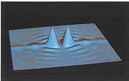
Abb. 6a Lichtverteilung im Bild eines leuchtenden Punktes bei Phasenverschiebung um eine halbe Wellenlänge zwischen den Pupillenhälften
