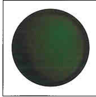
Abb. 10c Fernglas mit P-Belag zwischen zwei gekreuzten Polarisatoren mit der Dachkante parallel zur Polarisatorachse
