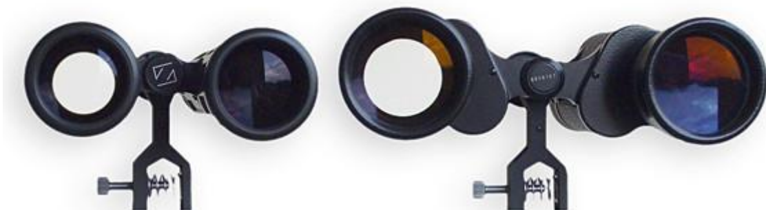
Blick auf die Objektive der beiden Kontrahenten, die Optik des Dialyt hat die effektivere Vergütung.
