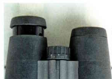
Optolyth ViaNova: Die Fokussierwalze in der Mitte der Brücke ist gut erreichbar, der Dioptrienausgleich ist vorn an der Brücke angebracht und in Stufen rastbar.
