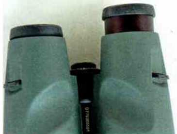
Swarovski SLC: Das Glas hat eine Kombiwalze, Drehaugenmuscheln und Daumenmulden auf der Unterseite.
